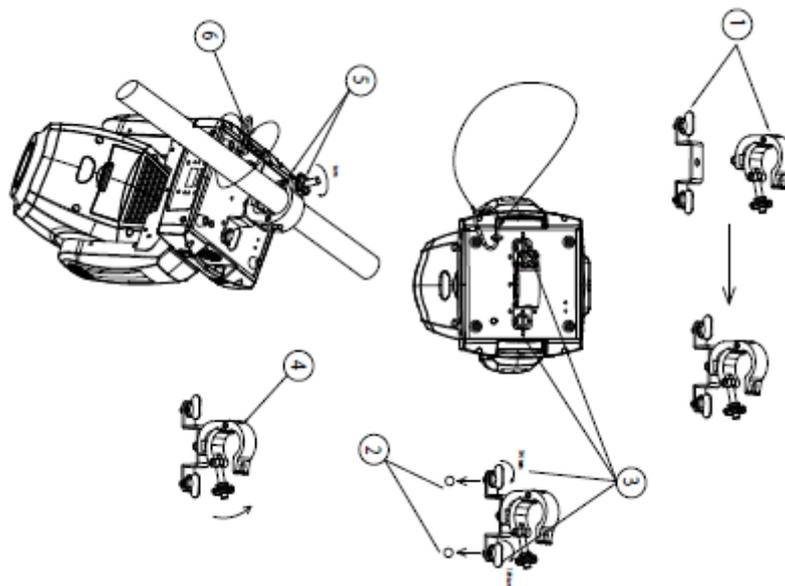
Schrauben Sie einen Klemmbügel mit einer Schraube M12 und einer Mutter an den Omega-Befestigungsbügel. Schieben Sie die Schnellverschlüsse des ersten Omega-Befestigungsbügels in die entsprechenden Aufnahmebohrungen am Boden des Inno Spot Elite. Drehen Sie die Schnellverschlüsse im Uhrzeigersinn fest. Ziehen Sie das Sicherheitskabel durch die Aussparung am Boden und über das Gerüst oder einen sicheren Befestigungspunkt. Schieben Sie das Ende in den Karabinerhaken und ziehen Sie die Schraube fest.
