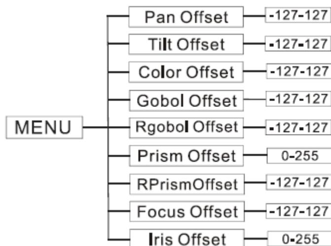
Um das Untermenü für die Einstellung der OTIL (Standardeinstellung)/Goboradeinstellung zu öffnen, betätigen Sie die ENTER-Taste für mindestens 3 Sekunden. In diesem Untermenü lassen sich die Ausgangspositionen verschiedener Funktionen testen: Schwenkung, Neigung, Farbrad, Goborad, RGoborad (rotierend), Prisma, RPrisma (rotierend) und Fokussierposition.
